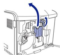
5. 請將感光滾筒固定桿，扳動至鎖定位置。
