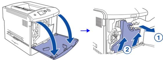
4. 移除感光滾筒和碳粉收集器之間的保護裝置，及感光滾筒固定桿的保護裝置。
