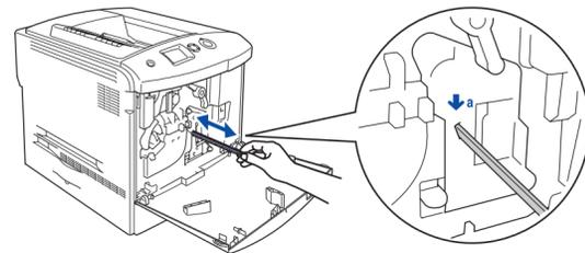
8. 依下圖所示，握住灰色雷射單元清潔棒的拉柄 [b]，慢慢地拉出再推入印表機，並重複數次，以清潔雷射單元的透明玻璃。
