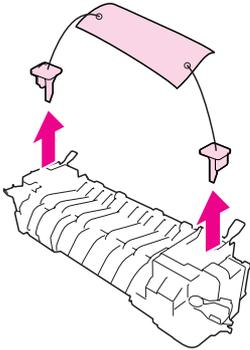
8. 將加熱器單元放入印表機，並將加熱器單元右側的凹槽對準印表機的卡榫插入。
