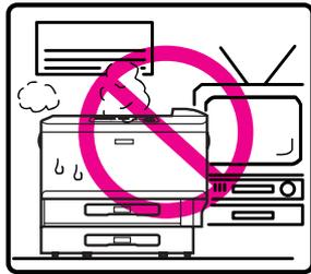
請勿將印表機放置在靠近電視機、收音機、除濕機、冷暖氣機出風口、或電扇直接吹拂的地方
