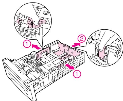
3. 請將一疊紙張放入紙匣 (列印面朝上)，調整左右紙張邊緣定位器，使其靠齊紙張的邊緣，然後依照您所放入的紙張大小調整後方定位器的位置。
