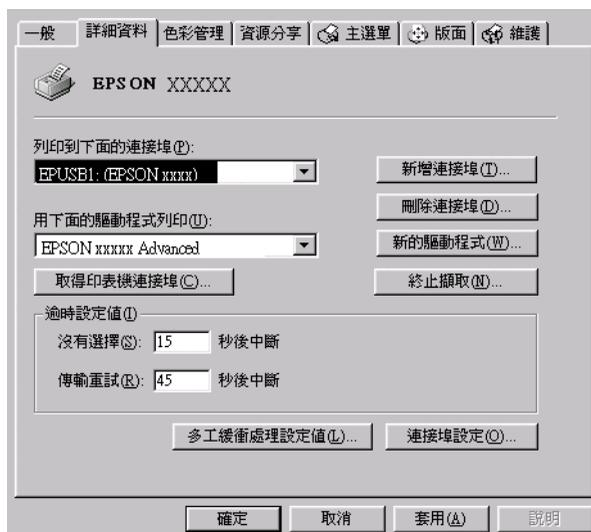
若 EPUSBX：(EPSON AcuLaser C3000) 出現在“列印到下面連接埠”清單中，表示 USB 印表機裝置驅動程式和印表機軟體的安裝是正確的。若沒有正確地顯示，請進行下一個步驟。
