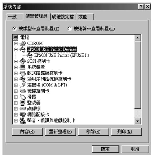
若“USB Printer”或“EPSON AcuLaser C3000”顯示在其他裝置下，則表示驅動程式的安裝不正確。請繼續進行步驟 5。
