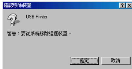
6. 請移除印表機軟體。然後關閉印表機的電源，重新開啓電腦的電源，然後依照安裝手冊中的步驟，重新安裝印表機軟體。
