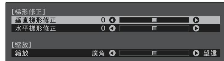
**3** 使用操作面板上的箭頭按鈕切換垂直及水平梯形修正，並視需要調整影像形狀。
