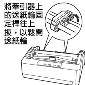
將牽引器上的送紙輪固定桿往上扳，以鬆開送紙輪
