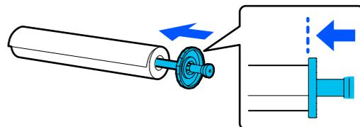
7 裝上並推入透明輪緣，直到輪緣與滾筒紙之間沒有任何間隙。
