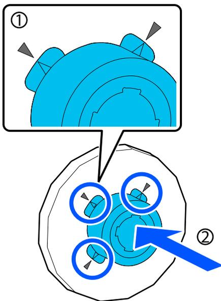
5 將滾筒紙放在平坦的表面上，然後插入滾軸。將黑色輪緣朝向右側，然後將滾筒紙的前緣朝向下圖所示方向。
