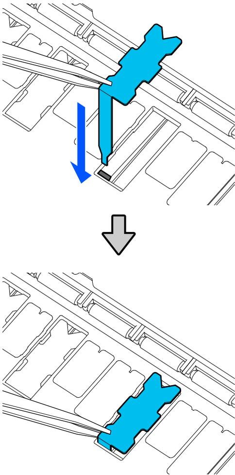
**8** 將無邊界列印墊片左側和右側的突出部分壓入左右兩側的溝槽內。
