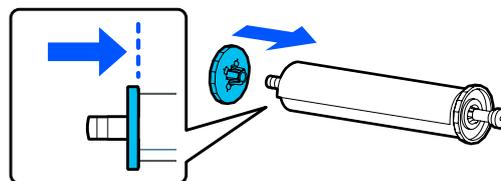
8 將滾軸的黑色輪緣朝向右側，然後將滾軸置於左右兩側的溝槽上。
