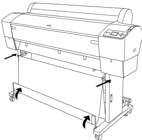
3. 鬆開前方的滑輪，並將腳架下方的固定旋鈕往上縮離地面。
