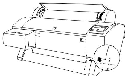
10. 將紙張固定桿推回鎖緊的位置，並且闔上滾筒紙蓋子。
