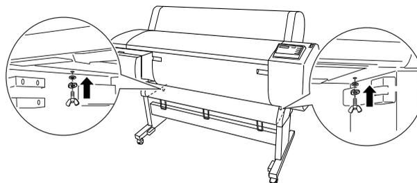
6. 鬆開前方的滑輪及固定旋鈕，並將印表機移到使用位置（指短距離移動）。將印表機移動到使用位置後，再鎖住滑輪並調整固定旋鈕。
