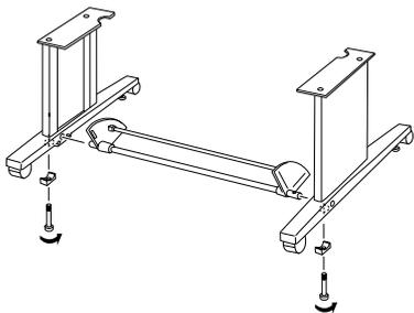
4. 將頂端的水平橫桿插入左右兩側的支撐架，並用螺絲起子鎖緊附有墊片的十字螺絲 (L)。
