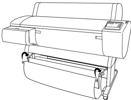
11. 如圖所示，將進紙支撐薄片鉤住紙張收集籃的中間橫桿，讓支撐薄片沿著收集籃的內部表面懸掛著。
