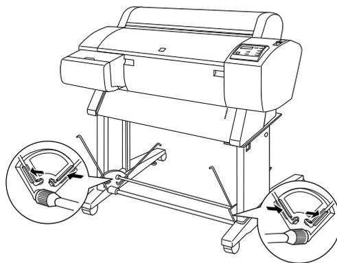
2. 將紙張收集籃後面的接頭卡入腳架後面收集籃掛鉤的頂端。請確定此接頭的銜接方式與位置與圖示中相同。
