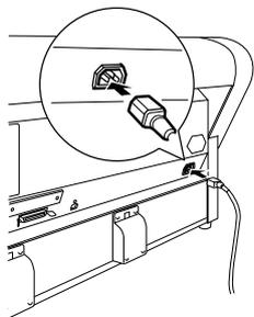
3. 將電源線穿過印表機後方的固定扣環。電源線可以從左邊或右邊穿過。
