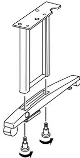
3. 如圖所示，將底部水平橫桿插入左右兩側的基座，並用六角扳手鎖緊橫桿上的橫桿螺絲，然後將栓塞塞入螺絲的上方。
