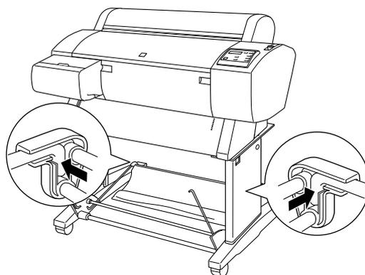
3. 旋轉紙張收集籃前面的接頭，將沒有連接布的橫桿捲入，如圖 (P) 所示。然後再將紙張收集籃前面接頭卡入腳架前面紙張收集籃掛鉤的頂端。請確定此接頭的銜接方式及位置與圖示 (Q) 中相同。
