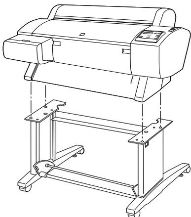
3. 使用蝴蝶螺絲 (N) 和墊片 (O) 來固定印表機的底部和腳架。
