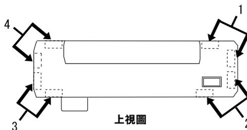
5. 用兩顆蝴蝶螺絲來固定印表機的底部及腳架。
