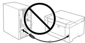
No conecte un cable USB a no ser que se le pida.
