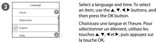
Sprache und Uhrzeit auswählen. Wählen Sie ein Element aus und verwenden Sie die Schaltflächen ▲, ▼, ◀, ▶ und drücken Sie dann die Schaltfläche OK.
