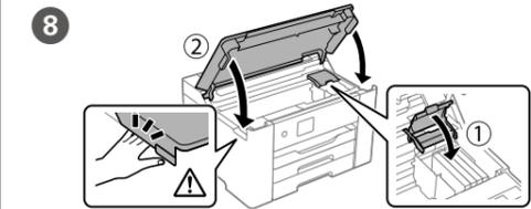
Wait until ink charging is finished. Patientez jusqu'à ce que le chargement de l'encre soit terminé. Warten Sie, bis die Tintenaufladung abgeschlossen ist. Wacht tot de inkt is geladen.
