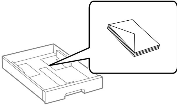
❑ 請在放入前攤鬆信封，然後將邊緣對齊。堆疊的信封因空氣而膨脹時，請在放入前將信封壓平。
