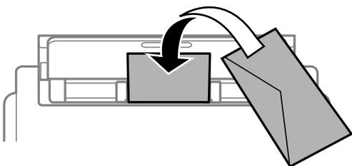
先在進紙匣放入信封，封口朝上，然後將邊緣定位器滑動到信封邊緣。
