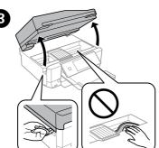
Open the scanner unit. 打開掃描單元。
